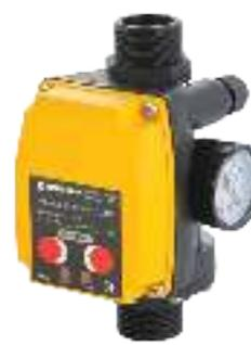
Блок АКВАРОБОТ ТУРБИПРЕСС М2 предназначен для автоматического управления однофазными насосами мощностью до 1,5 кВт по потоку жидкости и двум порогам давления  $R_{мин}$  и  $R_{макс}$ .
